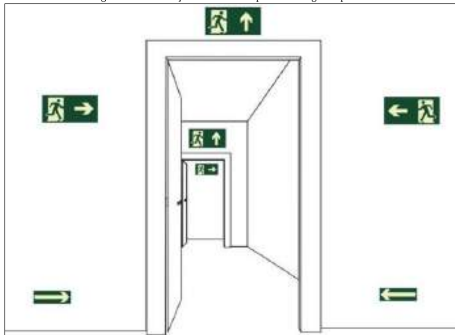
Figura 252. Sinalização de saída sobre paredes e vergas de portas
