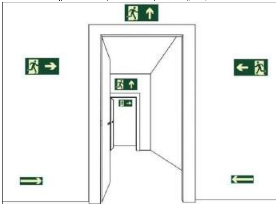
Figura 228. Sinalização de saída sobre paredes e vergas de portas
