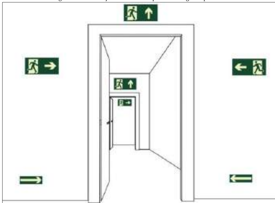
Figura 209. Sinalização de saída sobre paredes e vergas de portas
