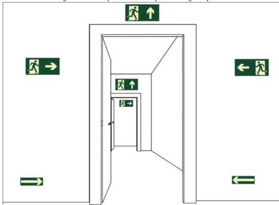
Figura 62. Sinalização de saída sobre paredes e vergas de portas
