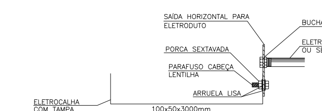
DETALHE DE SAÍDA PARA ELETRODUTO SEM ESCALA
